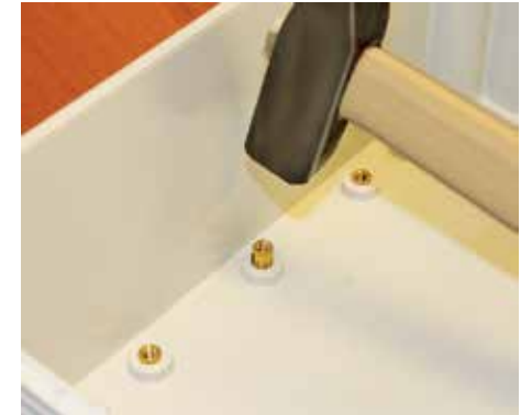
Aplique as inserções rosqueadas Insertar los insertos roscados
