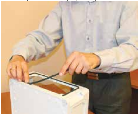
Insira o vedante Introducir en la ranura la junta de estanqueidad
