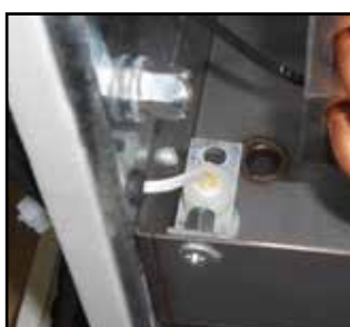
Disipador de agua de serie en toda la gama con dispositivo de seguridad que para la máquina en caso de anomalía de drenaje de condensación
