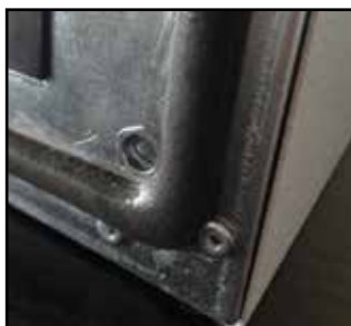
Junta en poliuretano puesta en colada continua
