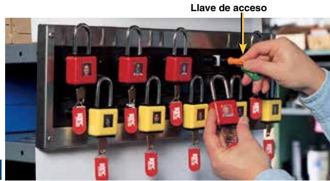
Este sistema de rastreo también puede ser usado para asegurar una amplia variedad de activos, incluyendo equipo asignado a empleados, equipo electrónico y de mantenimiento.
